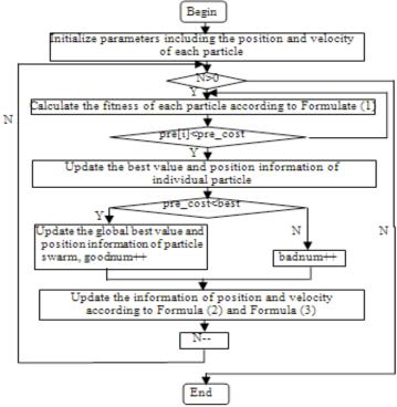
Fig. (1). Flowchart of PSO-NoC algorithm.
